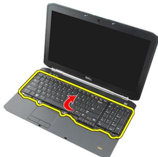
7. Quite la cinta de mylar que sujeta el cable de datos del teclado a la parte posterior de éste.
