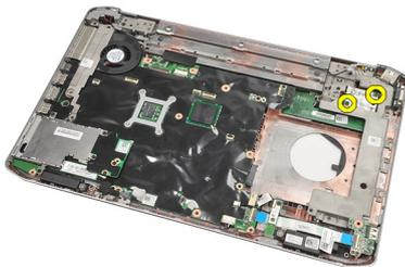
13. Levante la tarjeta de módem para soltarla del conector situado en la parte posterior y sáquela del equipo.
