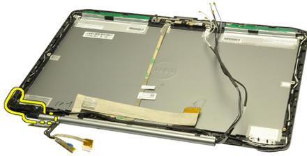
19. Suelte y saque la fijación de la bisagra izquierda de los cables.
