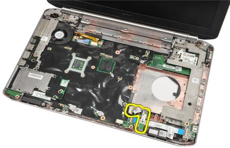
12. Desconecte el cable del Bluetooth de la tarjeta Bluetooth.
