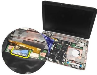
**13.** Desconecte el cable de la cámara.
