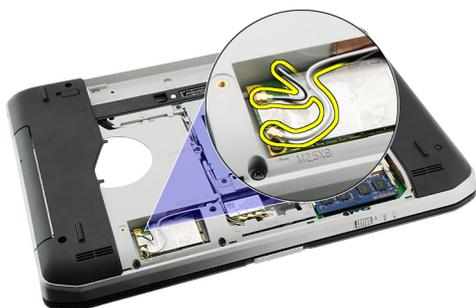
5. Extraiga el tornillo que fija la tarjeta WWAN a la placa base.
