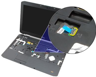
13. Desconecte el cable del botón de encendido.
