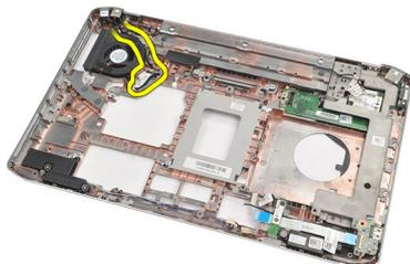
22. Quite el tornillo que sujeta el ventilador térmico.
