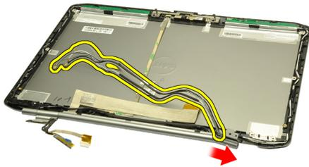
16. Tire de la fijación de la bisagra derecha a lo largo de los cables de la antena y sáquela.
