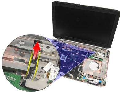
**15.** Quite los tornillos que fijan el ensamblaje de la pantalla al ordenador.
