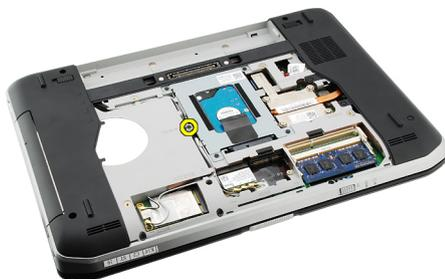
5. Presione la pestaña del tornillo para soltar la unidad óptica del compartimento.
