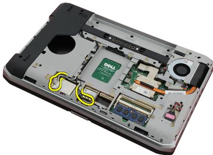
11. Retire los cables de la antena de las canaletas.
