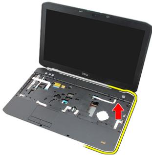
16. Suelte las pestañas del borde izquierdo del ensamblaje del reposamanos y extráigalo.
