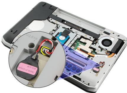
6. Levante y retire la batería del adhesivo.
