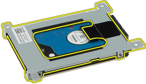
8. Desconecte el conector de la unidad de disco duro de dicha unidad.
