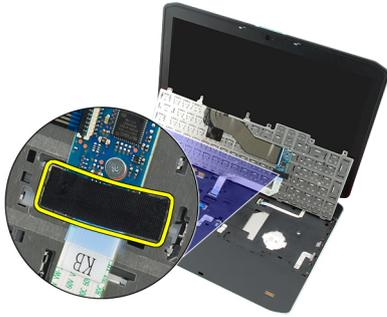
8. Desconecte el cable de datos del teclado.
