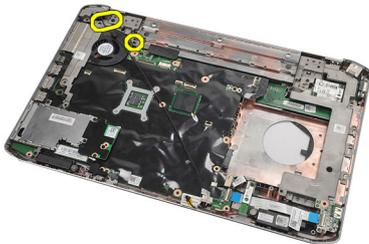
18. Deslice el soporte izquierdo a lo largo del cable del módem y sáquelo del ordenador.
