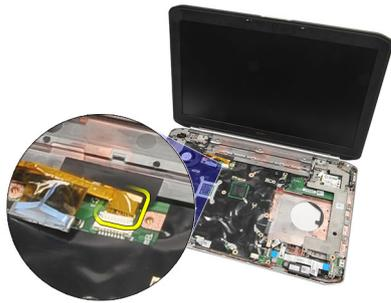
**14.** Pase los cables de la antena a través del orificio de la parte superior del equipo.
