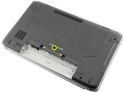
5. Dé la vuelta al equipo y quite los tornillos que fijan el teclado a la parte frontal del equipo.
