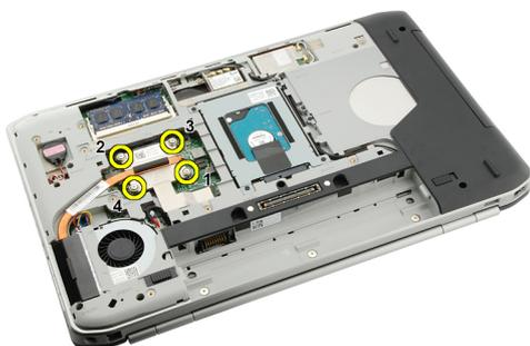
6. Levante el disipador de calor y extráigalo del equipo.
