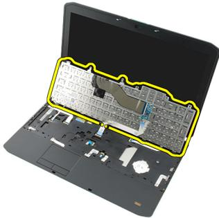
10. Desconecte el cable de datos del teclado y sáquelo del equipo.
